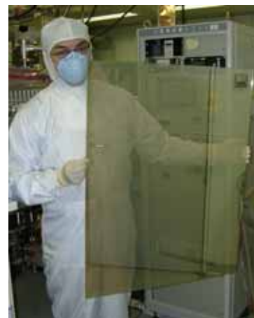
(680 × 880mm ガラス基板対応) 薄膜製造装置 製造したポリシリコン・マザーシートと江部社長
