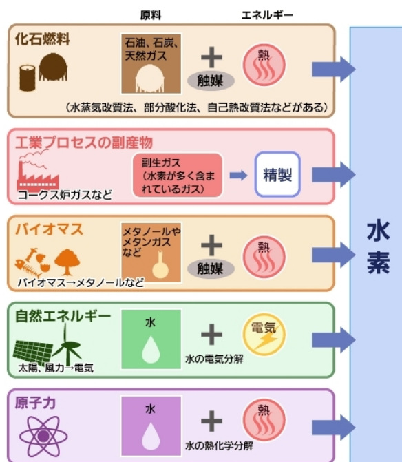
図 5-20 水素の工業的製造方法 21)
